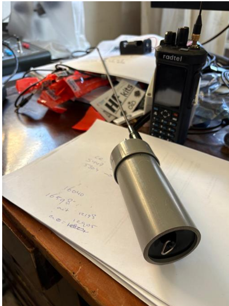
Figuur 5: Afgebouwde zender met gootsteenplug.
